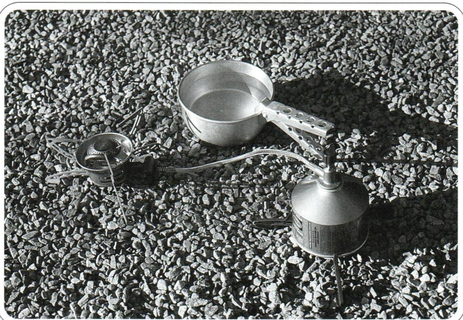
Primus gaskök LPS har en effekt på 3000 W. Förvärmningen av gasen när denna passerar rörbågen vid brännaren gör att köket klarar låga temperaturer bättre. Trefoten på gasbehållaren medför att denna står stadigt och samtidigt kommer upp en bit från den kalla marken.
