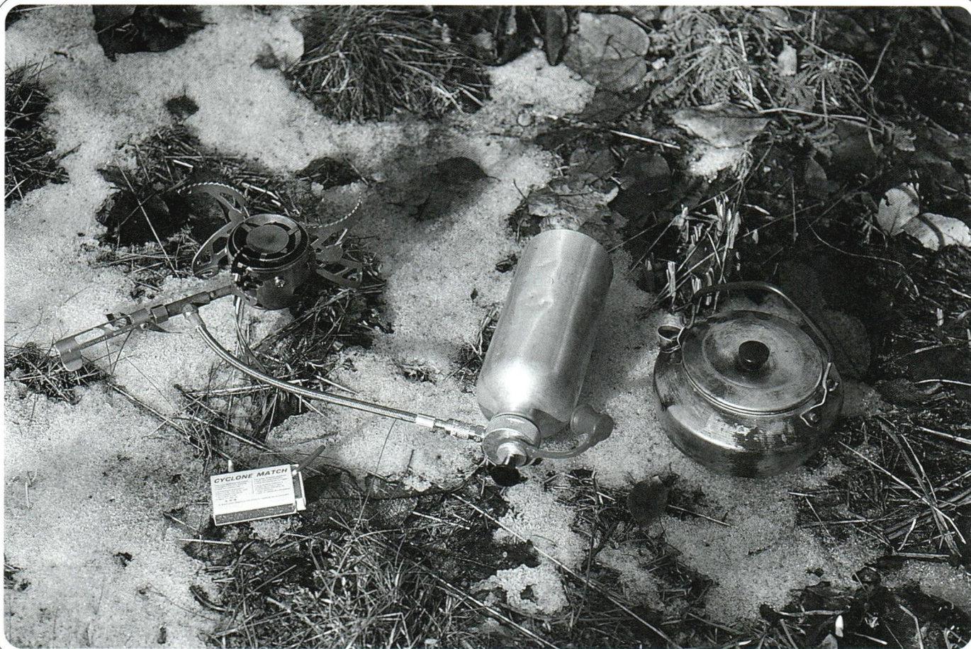
Fotogen- och bensinkök förses med övertryck genom pumpen på bränsleflaskan och är driftsäkra också vid låga temperaturer. Det är effektiva kök, som dock kräver några minuters förvärmning av brännaren, innan denna kan tändas. Optimus Nova kök har inbyggd rensnål i munstycket, vilket innebär en stor fördel vid drift med fotogen. (Foton på detta uppslag: Gunnar Johnson.)
