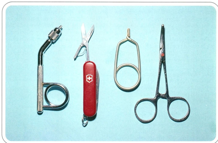
Handstäd, minisax med kniv, bryne och pincett, hackeltång och peang med böjd spets. Den senare fungerar utmärkt att använda som städ.
